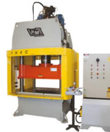
Gehärtete und verchromte Säulen führen den Stößel sehr genau. Die Maschine kann mit Auswerfern oder Tiefziehfunktion geliefert werden. Heizplatten oder mehrere Etagen sind möglich. Auf Wunsch fertigen wir die Presse mit Wartungsbalkon. Mit dieser Bauform sind Pressen mit bis zu einer Leistung von 4.000 T möglich.
