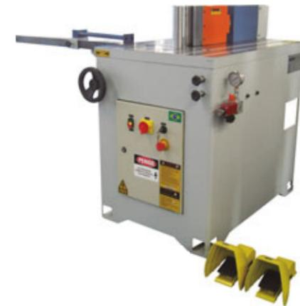
Kompakte leistungsstarke Maschine mit Fußbedienung, je nach Einsatz der Werkzeuge sehr vielseitig nutzbar. Biegen, Stanzen, Lochen bis zu 120 T.
